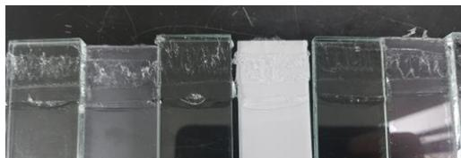
図 4. ポリカーボネートに対する凝集破壊の様子
