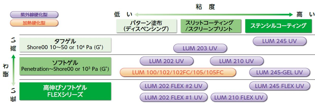
図 2. Wacker OCR 材の製品ポートフォリオ
